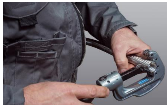
Обрезка торцов трубы
