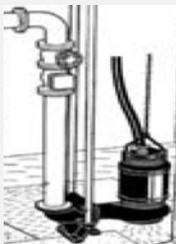
Стационарный погружной на автоматической трубной муфте, без охлаждающего кожуха
