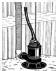
Погружной переносной без охлаждающего кожуха
