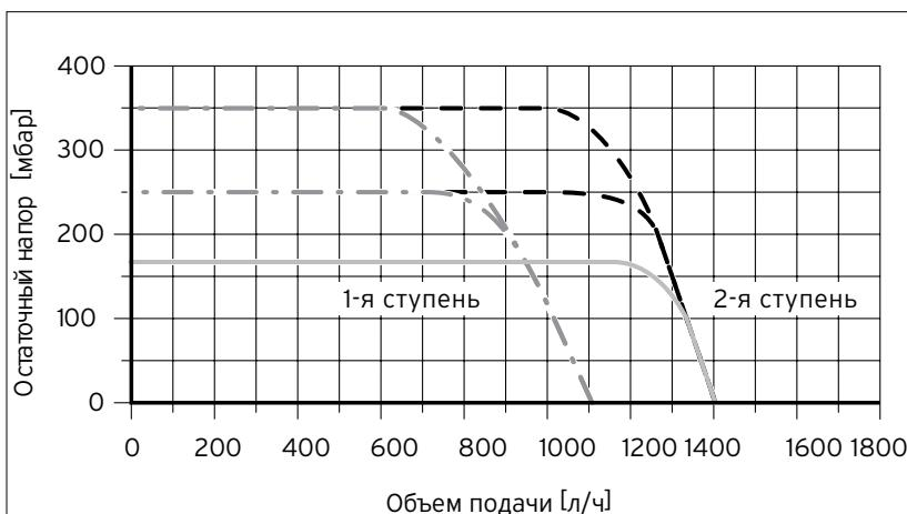
В газовых настенных отопительных аппаратах серии pro переход между 1-ой и 2-ой ступенем происходит вручную.
