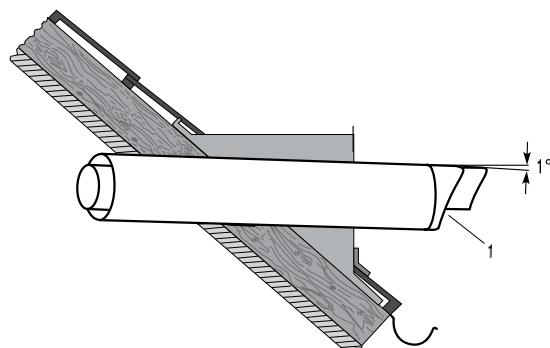
Прямой дымоход / воздуховод без использования удлинений и конденсатоотводчика. Уклон 1° в сторону улицы.
