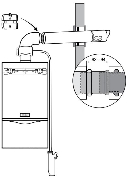
Прямой дымоход / воздуховод с использованием конденсатоотводчика. Уклон 3° в сторону котла.
