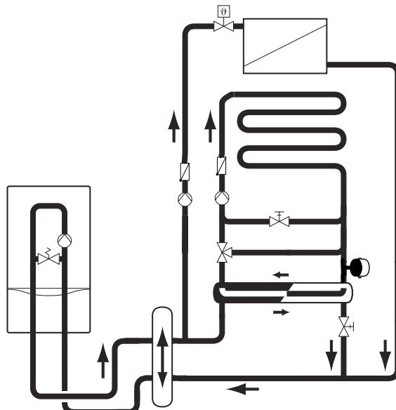
Принципиальная схема: 2-контура отопления.
