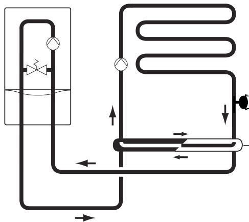
Принципиальная схема: 1-контур отопления (напольное отопление).
