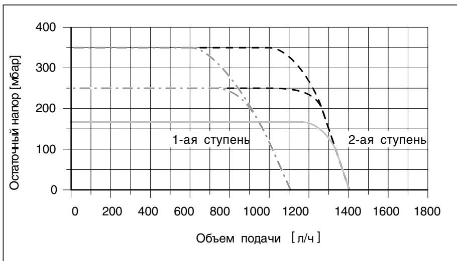
В газовых настенных отопительных аппаратах серии plus переход между 1-ой и 2-ой ступенью происходит под управлением электроники (в зависимости от настройки пункта меню D.19 ди-системы котла).
