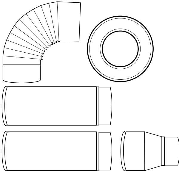
Набор для подключения котла atmoTEC к дымоходу (шахте) с естественной тягой.
