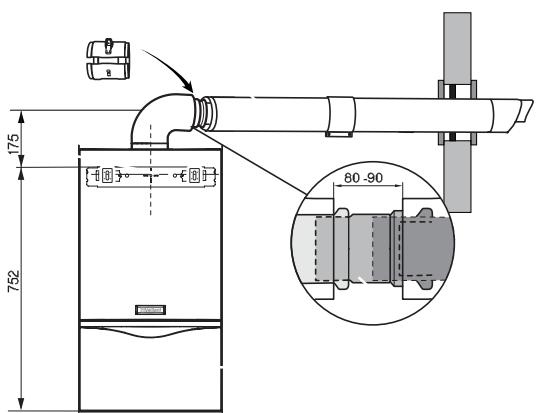
Горизонтальная концентрическая система дымохода / воздуховода ( $\varnothing 60 / 100$ )
