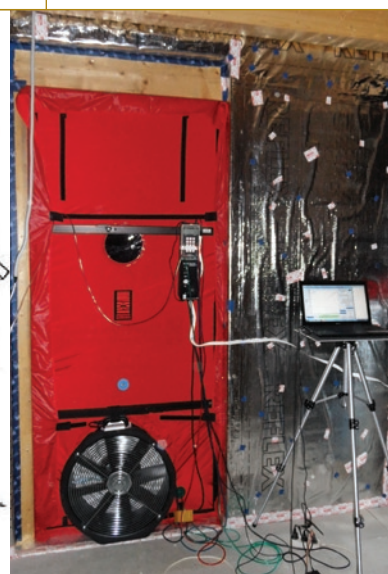
Рис. 5. Принцип BlowerDoor теста.
