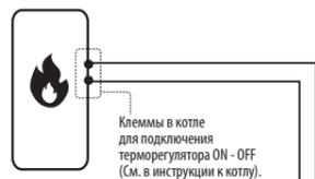
Клеммы в котле для подключения терморегулятора ON - OFF (см. в инструкции к котлу).
