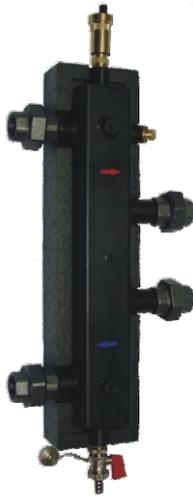
Гидравлическая стрелка CPN 70 изготовлена из стали. Она оборудована изоляцией, с верхней стороны двумя подключениями для датчика температуры и воздухоотводчика (резьба 1/2" GW), а с нижней стороны подключение для слива (резьба 1/2" GW). В комплекте находятся воздухоотводчик 3/8" с запорным клапаном 1/2", отверстие для датчика температуры 1/2", вентиль слива 1/2", четыре фитинга 1" чугунные, настенные ручки.
