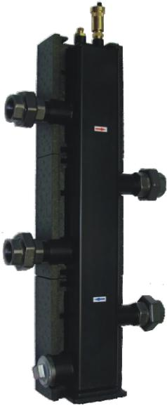
Гидравлическая стрелка CPN 100 она оборудована изоляцией а с верхней стороны двумя подключениями для датчика температуры и воздухоотводчика (резьба 1/2" GW), а с нижней стороны подключение для слива (резьба 2" GW). В комплекте находятся воздухоотводчик 3/8" с запорным клапаном 1/2", отверстие для датчика температуры 1/2", четыре фитинга 1 1/2" чугунные.
