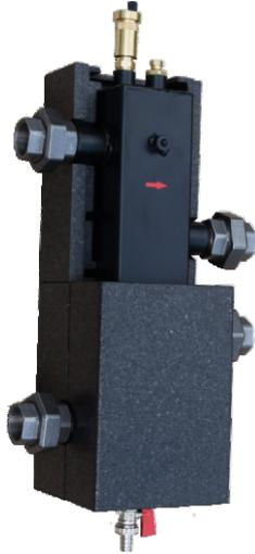
Гидравлическая стрелка CPN 100 DN 32 изготовлена из стали. Она оборудована изоляцией, с верхней стороны двумя подключениями для датчика температуры и воздухоотводчика (резьба 1/2" GW), а с нижней стороны подключение для слива (резьба 1/2" GW). В комплекте находятся воздухоотводчик 3/8" с запорным клапаном 1/2", отверстие для датчика температуры 1/2", вентиль слива 1/2", четыре фитинга 1 1/4" чугунные, настенные ручки.
