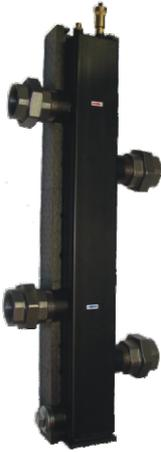
Гидравлическая стрелка CPN 120 - DN 65 изготовлена из стали. Заводом она оборудована изоляцией, с верхней стороны двумя подключениями для датчика температуры и воздухоотводчика (резьба 1/2" GW), с нижней стороны подключение для слива (резьба 2" GW). В комплекте находятся воздухоотводчик 3/8" с запорным клапаном 1/2", отверстие для датчика температуры 1/2", четыре фитинга 2 1/2" чугунные.
