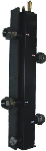
Гидравлическая стрелка CPN 120 - DN 50 Заводом она оборудована изоляцией, с верхней стороны двумя подключениями для датчика температуры и воздухоотводчика (резьба 1/2" GW), а с нижней стороны подключение для слива (резьба 2" GW). В комплекте находятся воздухоотводчик 3/8" с запорным клапаном 1/2", отверстие для датчика температуры 1/2", четыре фитинга 1 1/2" чугунные.
