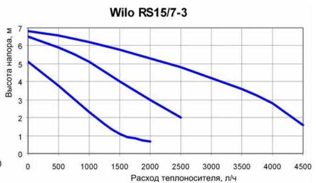
Рис.19. Высота напора насоса «Wilo RS15/7-3»
