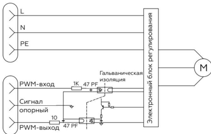
Входной сигнал PWM (P1 – отопление).
