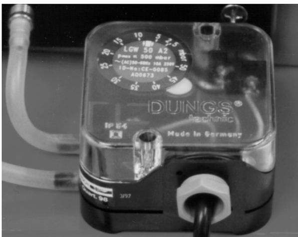
Реле контроля давления воздуха работает как дифференциальное реле давления и служит для контроля давления у горелок с наддувом. На заводе реле контроля давления воздуха предварительно установлено
