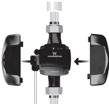
Рис. 8 Установка теплоизолирующего кожуха
