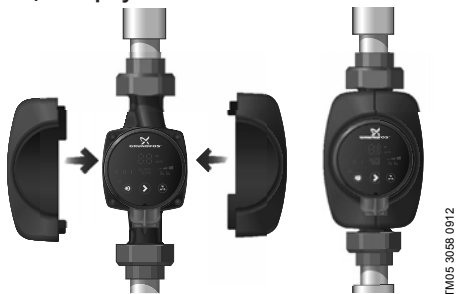
Рис. 8 Изоляция корпуса насоса
