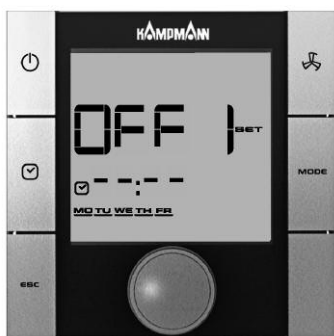
Режим ввода «Время выключения»
