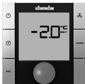
Параметр P36 = 1 настройка заданной температуры ± 3K
