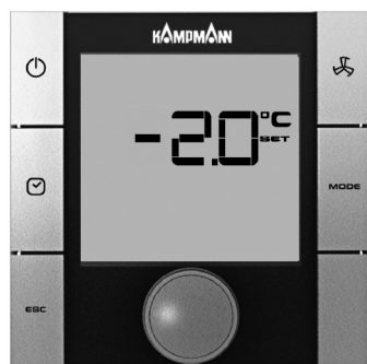
Параметр P36 = 1 настройка заданной температуры ± 3K
