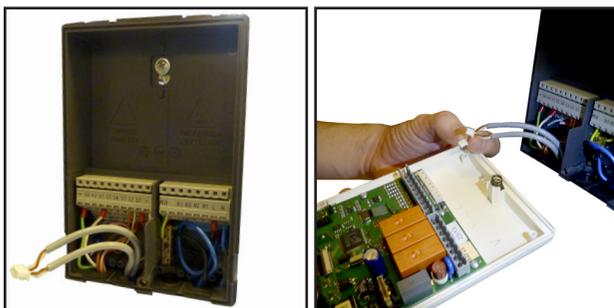
SmartWeb L имеет разъемы с ножевыми контактами. Поэтому основная лицевая часть контроллера легко снимается, а весь электромонтаж ведется на ответной части контроллера, где и расположены клеммы.
