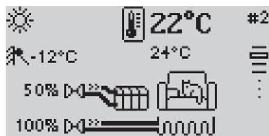
Эта программа нужна для контроля температуры в помещении. Комнатное устройство сообщает контуру отопления, отвечающему за обогрев помещения, значения текущей и требуемой температур. Отопительный контур, в свою очередь, корректирует свою работу в зависимости от полученных от комнатного устройства данных.
