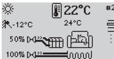
Программа предназначена для поддержания заданной температуры в помещении. Комнатное устройство сообщает контуру отопления значения текущей и требуемой температур помещения.
