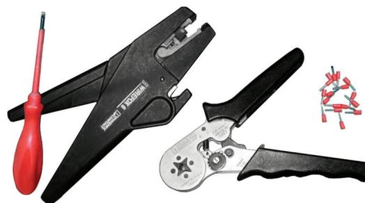
Нужно «вооружиться» теперь уже практически стандартным инструментом для зачистки изоляции и обжима провода и обжимными наконечниками с длиной металлической части 8-10 мм как показано на рисунке. Может понадобится и тонкая плоская отвертка с шириной 2.5мм.
