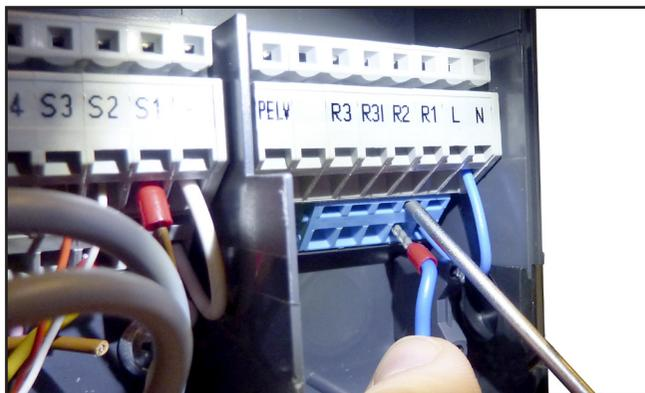
Контакты на разъемах размечены графически точно так же, как и на электросхеме (с. 14). Поэтому определение нужного контакта не составляет труда.
