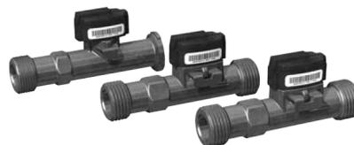
Датчики VFS сочетают в себе одновременно и датчик температуры, и датчик скорости потока. 4-х проводной. Может применяться в связке с программой проточного приготовления горячей воды в контроллерах SmartWeb S/L.
