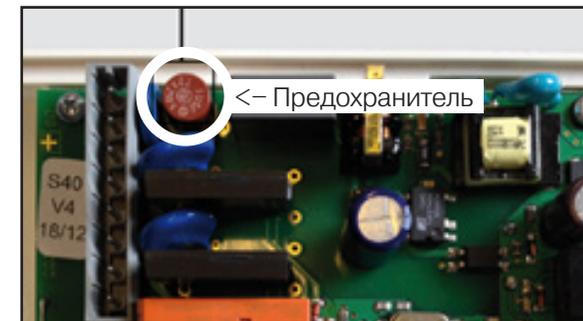
Силовые цепи контроллера защищены общим предохранителем 2А. Предохранитель находится на основной лицевой части прибора.
