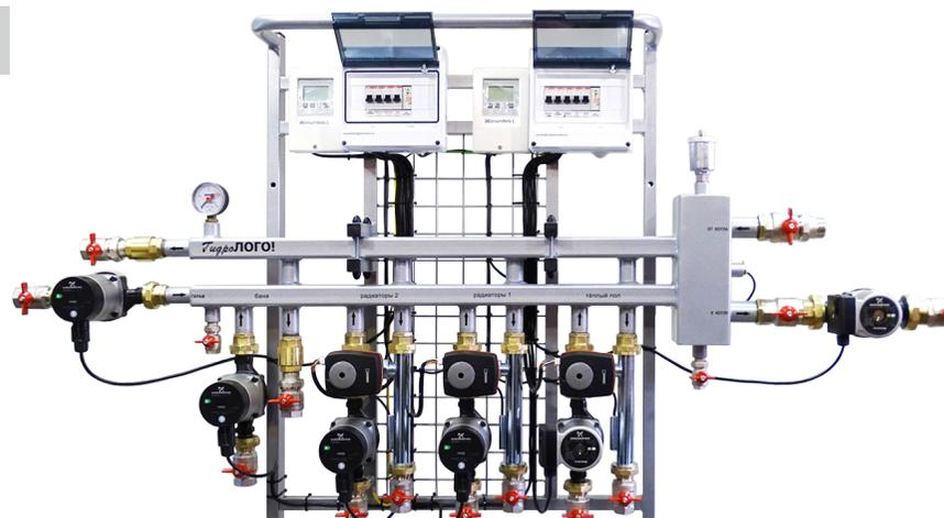
Похожий Модуль на базе коллектора с интегрированной гидрострелкой Супер-Стандарт 5-90, всего на 5 потребителей DN25, с управлением которых справляются 2 контроллера SmartWeb L, которые предварительно собраны в документированные стандартные бокс-сборки.
