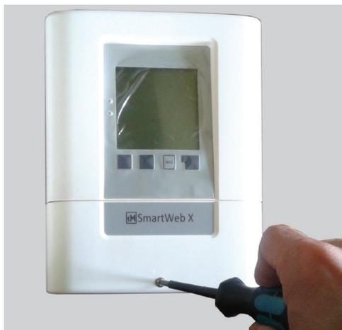
Под крышкой находятся клеммы силовых и слаботочных контактов контроллера.
