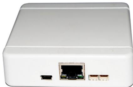
Устройство локального мониторинга контроллеров серии TM-SmartWeb
