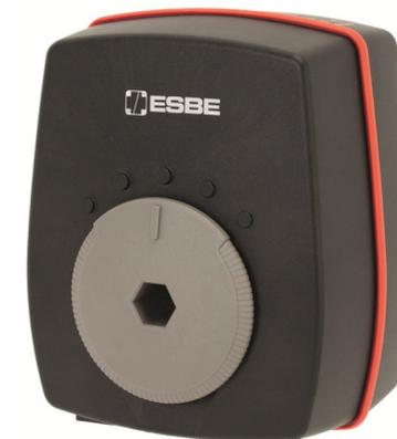
Сервопривод ARA598 с управлением сигналом PWM (широтно-импульсная модуляция) или пропорциональным сигналом (0-10В или 0-20мА) имеет напряжение питания =12-24В, или ~24В .
