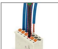
При использовании многожильного провода используйте маленькую отвертку и нажимайте на оранжевые кнопки на разъеме. При использовании твердого кабеля или обжатого наконечника, просто вставляйте провод в разъем.
