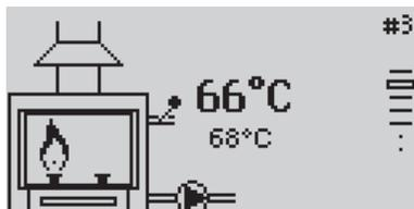
Программа котла выполняет функцию нагрева теплоносителя до необходимой температуры. Под котлом понимается нагреватель с одной или двумя степенями нагрева (или модулирующим сигналом), циркуляционным насосом и датчиком температуры теплоносителя на выходе из котла.
