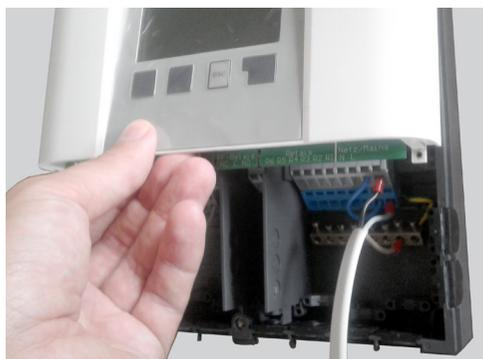
После этого нижняя часть панели будет извлечена из ножевых контактов клемм, расположенных на тыльной крышке.
