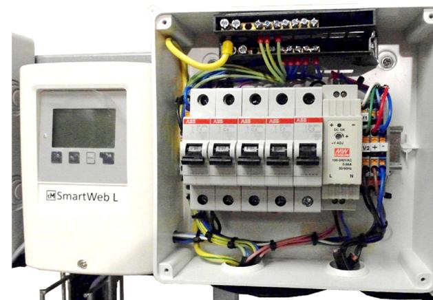
«Внутренности» одного из 5-ти доступных вариантов бокс-сборки контроллера SmartWeb L. В зависимости от варианта в состав бокс-сборки могут входить и дополнительные блоки питания быстрых аналоговых сервоприводов, и переходные реле с 12в на 220в или с 220в на «сухой контакт», и дополнительные клеммники, и размеченные АЗС управляемых силовых элементов (например, насосов).
