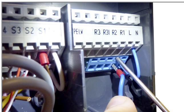
Контакты на разъемах размечены графически точно так же, как и на электросхеме (с. 16). Поэтому определение нужного контакта не составляет труда.
