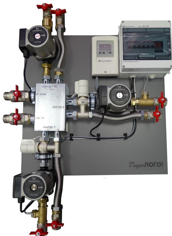
Управляемый модуль МИКРО 3-50 на базе миниатюрного гибридного коллектора Супер-Стандарт 3/50 со встроенной гидрострелкой с 2-мя насосно-смесительными контурами и одним насосным контуром бойлера ГВС. Управление от бокс-сборки 2VR+R с контроллером SmartWeb L. Самый недорогой вариант реализации этой задачи в своем классе ДН20. Смонтировано на компактной композитной рамке.
