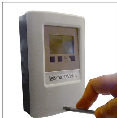
Разборка контроллера также начинается с выкручивания центрального фиксирующего винта.
