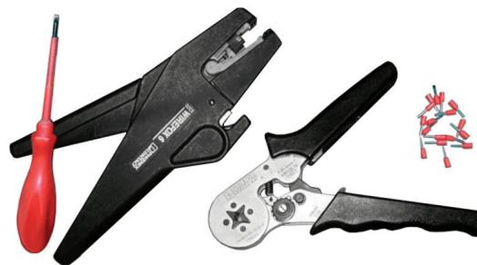
Нужно «вооружиться» теперь уже практически стандартным инструментом для зачистки изоляции и обжима провода и обжимными наконечниками с длиной металлической части 8-10 мм как показано на рисунке. Может понадобиться и тонкая плоская отвертка с шириной 2.5мм.
