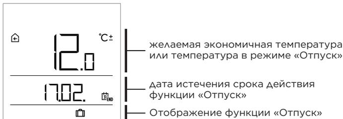
Теперь мы можем изменить желаемую экономичную температуру с помощью кнопок **+** и **-**. Измените настройку, пока значение мигает. Нажимая кнопку ECO или **i**, мы переходим к настройке даты. Используйте кнопки **+** и **-**, чтобы установить дату, до которой должно работать отопление во время отпуска.
