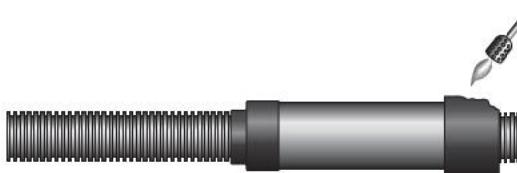
Использовать термопистолет (фен) или минигорелку с мягким желтым пламенем (НЕ ИСПОЛЬЗОВАТЬ синее пламя!), чтобы мягко осадить каждую мягкую муфту таким образом, чтобы половина ее попадала на жесткую муфту, а вторая половина – на наружный кожух трубы.
