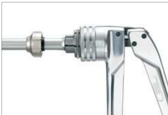
Рис. 15-7 Произвести развальцовку присоединительной трубки
