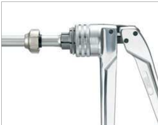
Рис. 15-3 Произвести развальцовку концевой участка трубки
