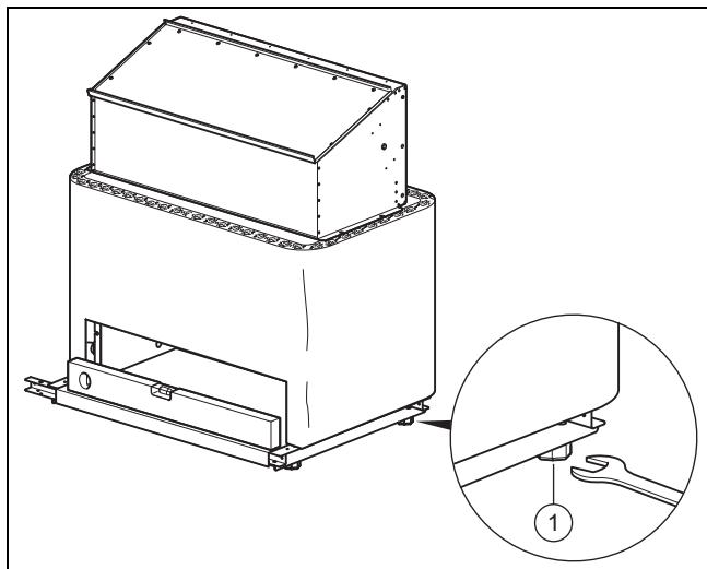
1. Выровняйте блок котла с помощью регулируемых ножек (1) так, чтобы блок котла стоял горизонтально. Используйте для этого плоский ключ с открытым зевом 30 мм.
