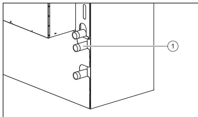
2. Подсоедините газопровод с резьбовым соединением к газовой сети (1). При этом обратите внимание на то, чтобы газопровод не испытывал механических напряжений.
