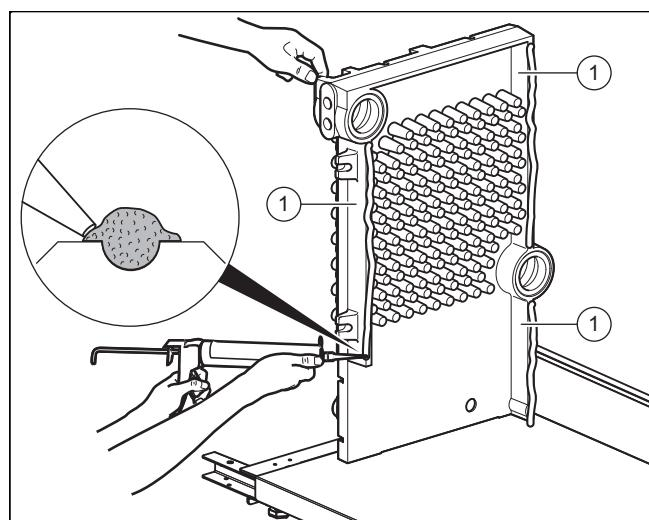
1. Нанесите герметик сплошной полосой по всей длине уплотнительной планки (1). Используйте прилагаемый силикон. Работайте с 8 мм отверстием в наконечнике.
