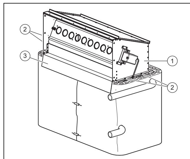
2. Наденьте коллектор отходящих газов (1) на уплотнительную ленту так, чтобы панель (3) оказалась снаружи теплоизоляции.
