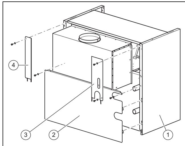
1. Вставьте заднюю стенку (2) фиксаторами в прорези боковых частей обшивки (1). Прикрутите заднюю стенку двумя винтами.
