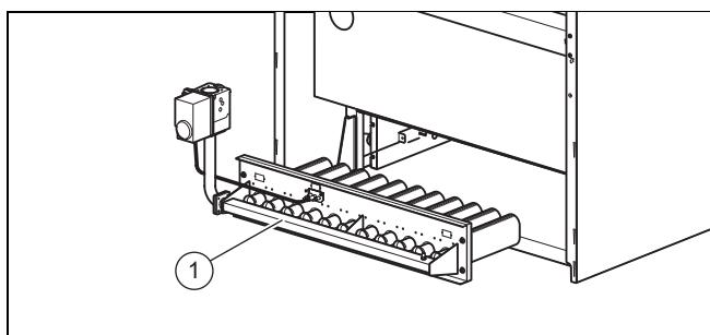
1. Вставьте консоль горелки (1) спереди назад. При этом отверстия должны проходить над резьбовыми штифтами.
