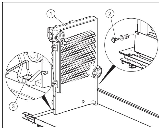
2. Расположите концевую секцию (1) на раме. Зафиксируйте концевую секцию.
