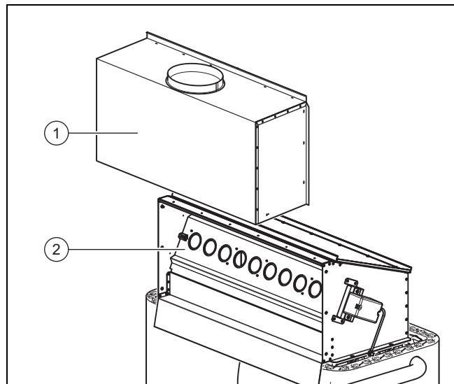
1. Установите предохранитель тяги (1) на коллектор отходящих газов (2).
