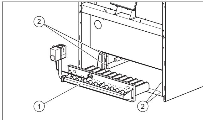
1. Вкрутите четыре резьбовых штифта в четыре отверстия (2) обеих концевых секций.
