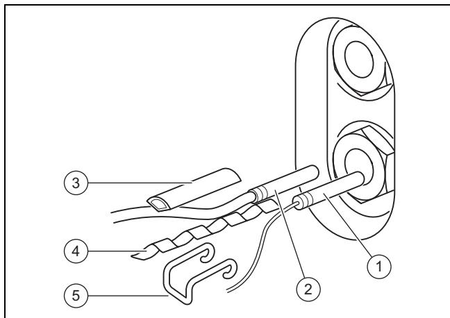
1. Положите оба датчика температуры (1) и (2) и пустую гильзу (3) и зажимную пружину (4) в один пакет.
