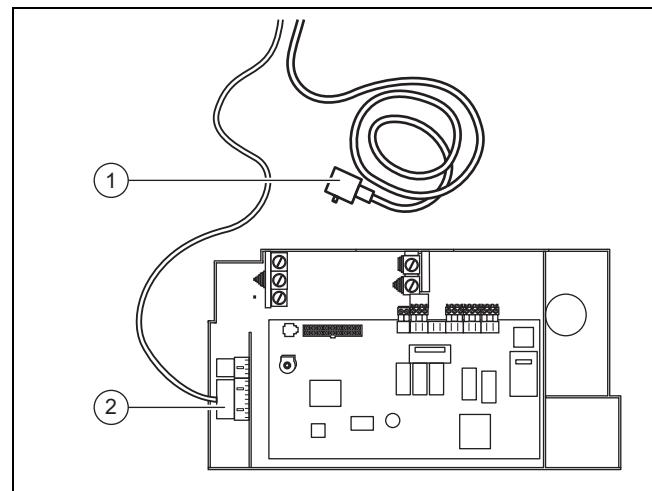
1. Проведите соединительный кабель от коллектора отходящих газов (с сервоприводом заслонки отходящих газов) к распределительной коробке.
