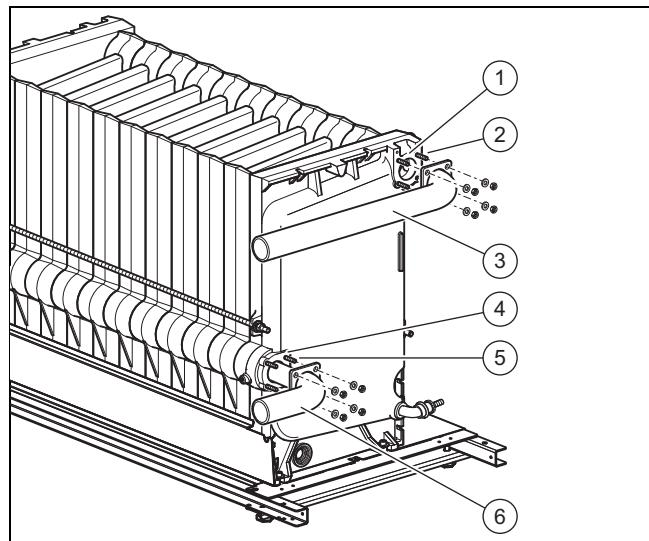
1. Вкрутите четыре резьбовых шпильки (2) (концом с короткой резьбой) в резьбовые отверстия втулки подающей линии (1) в левой концевой секции.
