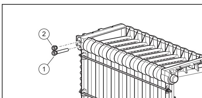
1. Уплотните резьбу погружной гильзы (1) пенькой. Прикрутите погружную гильзу к левой концевой секции.
