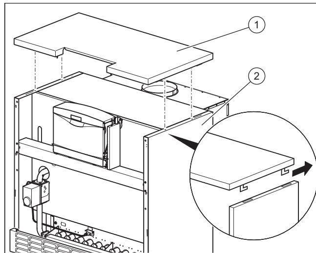
1. Вставьте крышку облицовки (1) фиксаторами в прорези боковой облицовки (2) сверху вниз.
