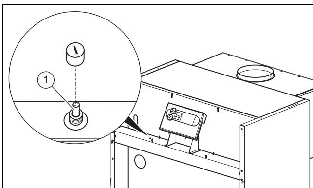
1. Смонтируйте предохранительный ограничитель температуры (1) на поперечине, слева рядом с распределительной коробкой.
