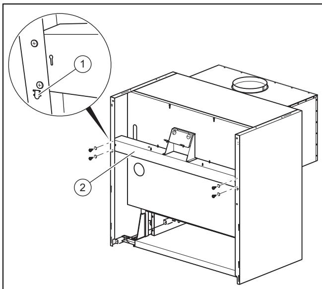
1. Вставьте поперечину (2) обоими выступами (1) в прорези боковой облицовки.
