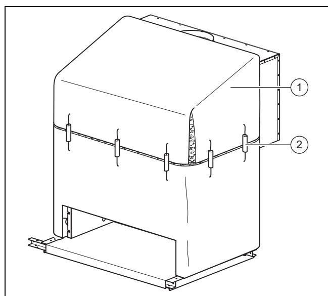
1. Установите теплоизоляцию (1) на коллектор отходящих газов. При этом следите, чтобы теплоизоляция плотно прилегала к коллектору отходящих газов.
