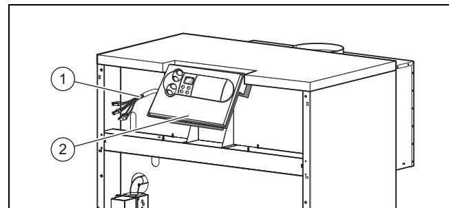
1. Используйте клеммы для подключения на кабельном жгуте (1) или в распределительной коробке (2).
