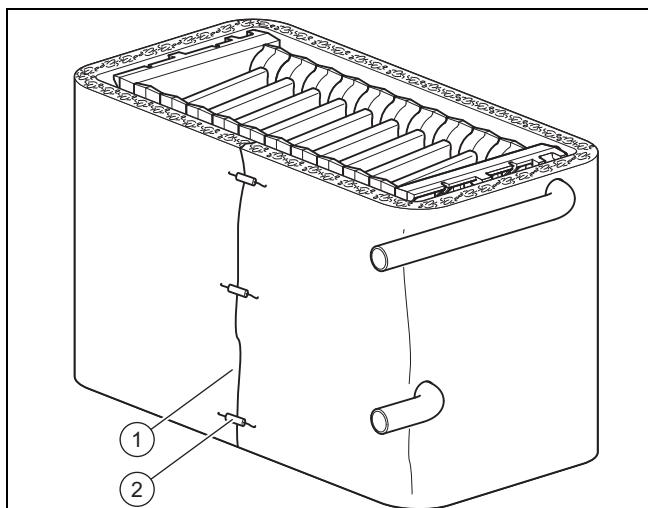
1. Установите теплоизоляцию (1) на блок котла. Для этого вставьте подающую и обратную линии в отверстия в теплоизоляции и полностью обложите ею блок котла.
