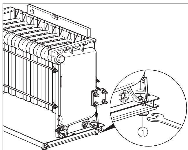
1. Выровняйте блок котла с помощью регулируемых ножек (1) так, чтобы блок котла стоял горизонтально.
