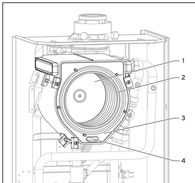
2. Очистите нагревательную спираль (2) теплообменника (3) уксусом (макс. 5% кислоты).
