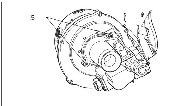
7. Ослабьте оба крепежных винта (5) на газовой арматуре.
