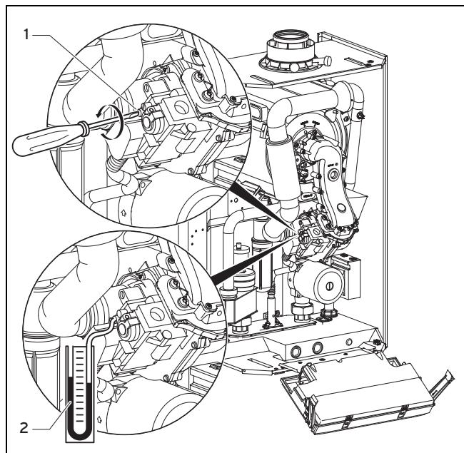
2. Ослабьте обозначенный **in** винт измерительного ниппеля (1) на газовой арматуре.
