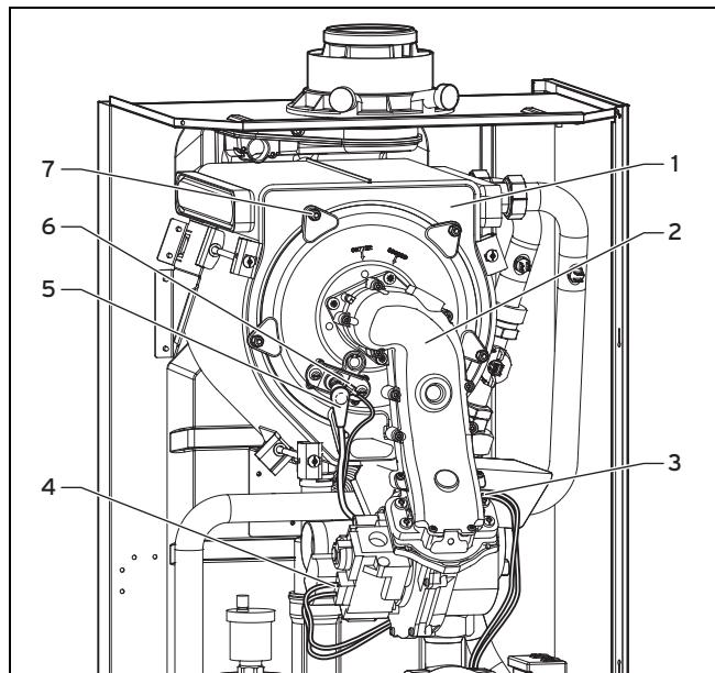
7. Отсоедините штекер провода розжига (5) и провода заземления (6) от электрода розжига.
