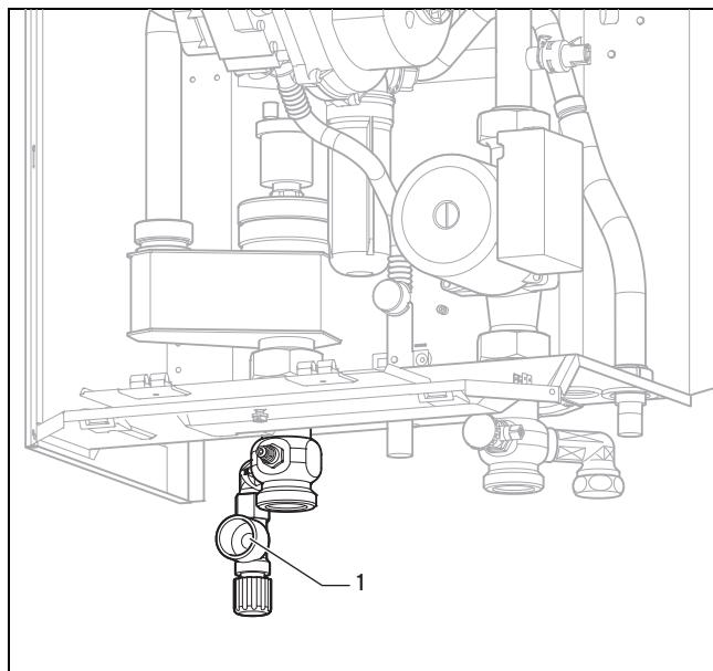
1. Смонтируйте прилагаемый предохранительный клапан.
