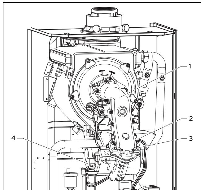
1. Снимите воздухозаборную трубу.
