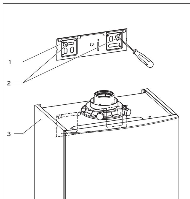
1. Смонтируйте на стене держатель аппарата (1) с помощью дюбелей и винтов (2) из комплекта поставки.
