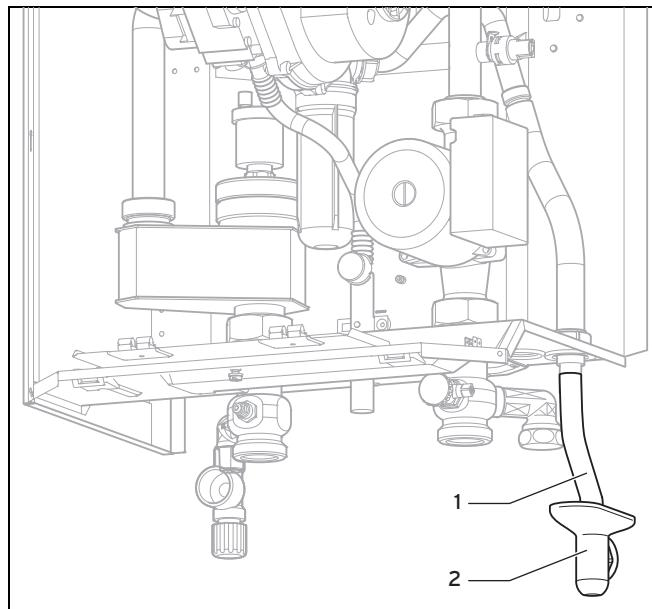
В результате сгорания топлива в изделии образуется конденсат. Линия отвода конденсата (1) отводит конденсат через сливную воронку (2) к присоединительному патрубку канализации.
