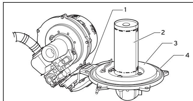
1. Проверьте поверхность горелки (2) на наличие повреждений. При обнаружении повреждений замените горелку.
