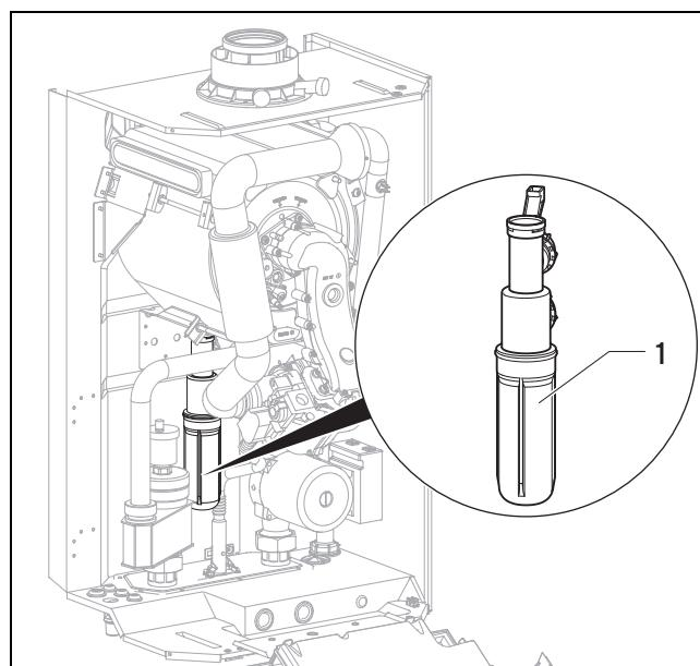
1. Снимите нижнюю часть сифона (1), повернув нижнюю часть против часовой стрелки.
