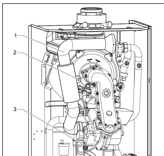
5. Выверните удерживающий винт (2) и снимите воздухозаборную трубу (1) со всасывающего штуцера.
