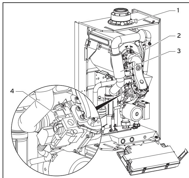
3. Измерьте содержание CO<sub>2</sub> на измерительном патрубке отходящих газов (1).
