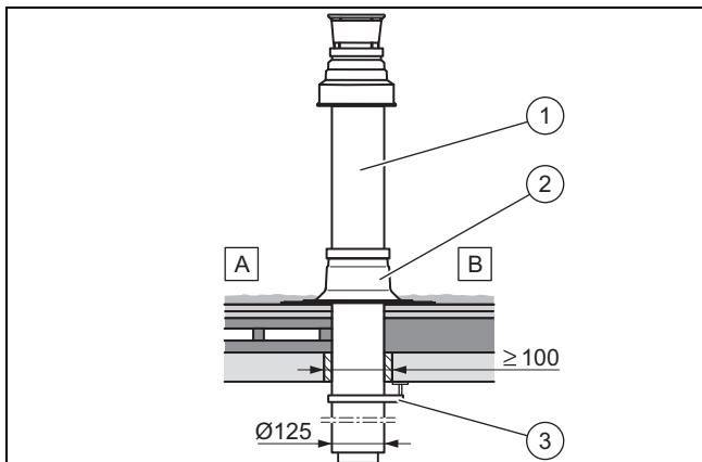
A Неутепленная крыша      B Утепленная крыша
