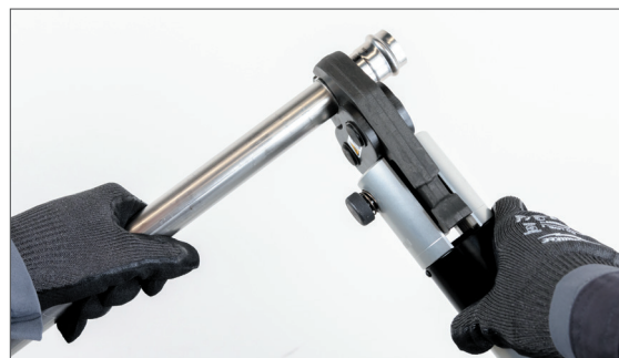
Рис. 14 Запрессовка (обжим) соединения
