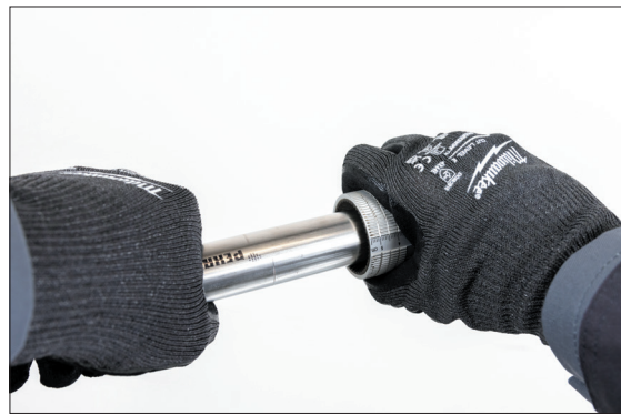
Рис. 9 Снятие фаски с трубы d15-54 мм
