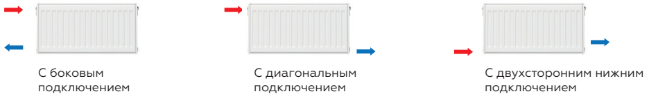
Рис.2 Схема подключения радиаторов серии ERK
