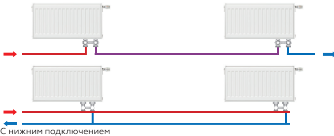
Рис.3 Схема подключения радиаторов серии ERV
