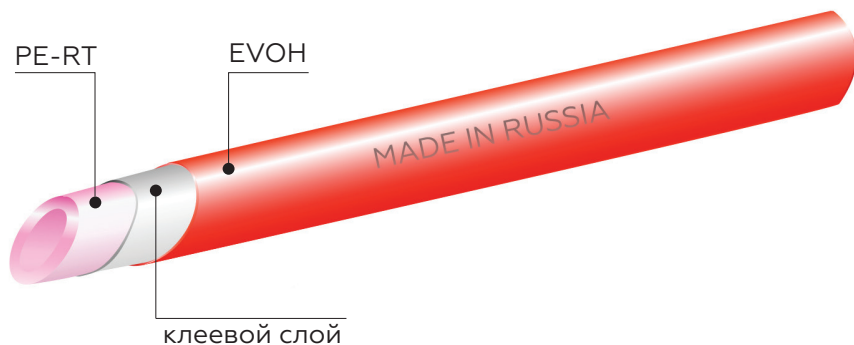
Рис.1 Конструкция труб серии EPF
