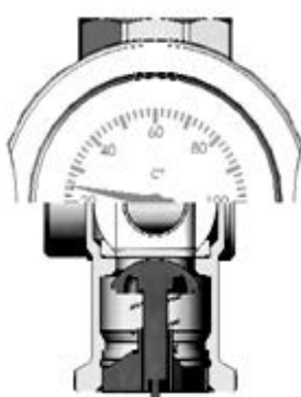
Шаровой кран открыт, обратный клапан в автоматическом режиме.
